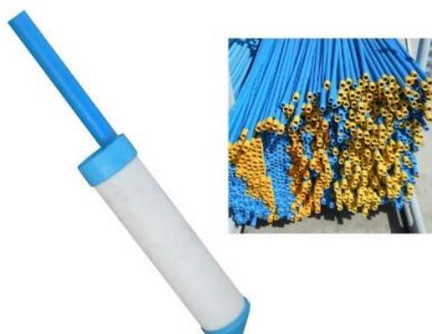
Il Piezometro di Casagrande fornisce la **misura della pressione interstiziale del terreno.**
